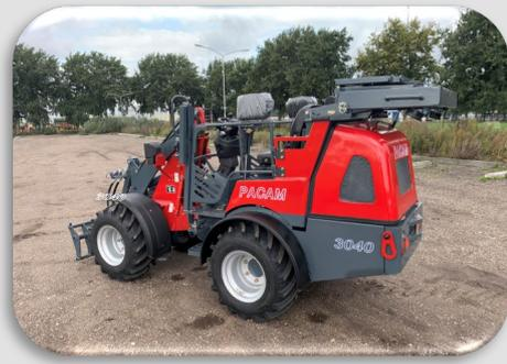
**3040 Fahrerschutzdach klappbar**
