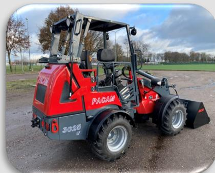
**3025 LF Fahrerschutzdach klappbar**
